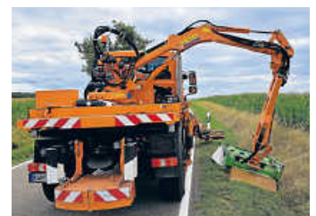
Der Ökomähkopf wird von den Straßenmeistereien in Öhringen und Künzelsau in zwei Mähzeiträumen eingesetzt und getestet. Insekten und Kleinlebewesen können mit dieser Mähtechnik geschützt werden
